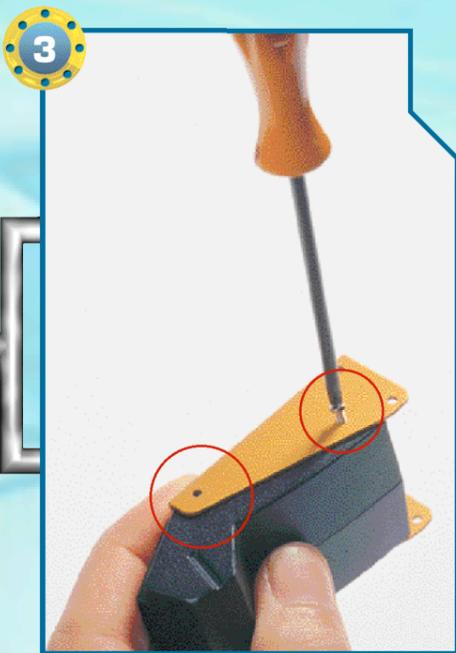
3 Recuperiamo ora 4 viti tipo T-2 da 2x5 mm e utilizziamole per mantenere uniti gli elementi appena assemblati. Ne saranno necessarie due per ogni lato, inserendole nei fori evidenziati in figura. Le viti andranno serrate saldamente, ma senza forzare per non rischiare di 'spanare' i fori.
