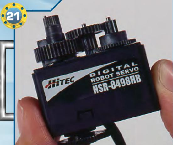
◀21▶ Dopo l'assemblaggio dell'ultima ruota dentata, il servomotore dovrà apparire come nella figura qui sopra. Controlla che le ruote dentate siano correttamente inserite e allineate.
