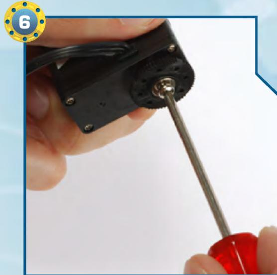
6 ▶ Utilizziamo una vite di tipo T-2 da 2,6x6 mm per fissare al servomotore la squadretta in plastica. Essa non è attuata dal motore elettrico, ma serve esclusivamente per la connessione delle squadrette in alluminio, necessarie a realizzare varie configurazioni robotiche.
