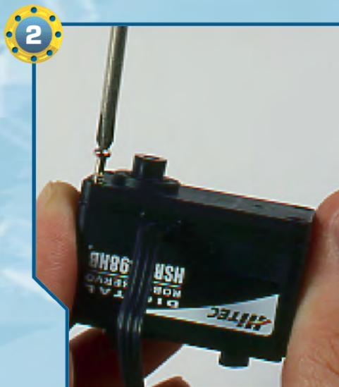
2 Per fissare i due elementi appena assemblati, utilizziamo quattro viti di tipo T-2 da 2x12 mm, serrandole lungo gli appositi fori presenti sulla base inferiore in plastica.
