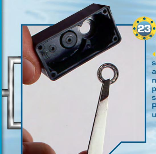
◀23▶ Prendiamo il secondo cuscinetto a sfera e inseriamolo nella fessura circolare presente sulla base superiore del servo. Per facilitare l'operazione, utilizziamo la pinzetta.
