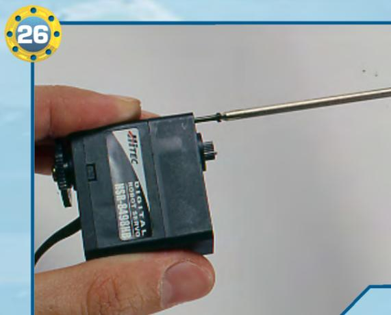
◀26▶ Utilizziamo ora le 4 viti di tipo T-2 da 2x21 mm per affrancare la base superiore in plastica sul servomotore.
