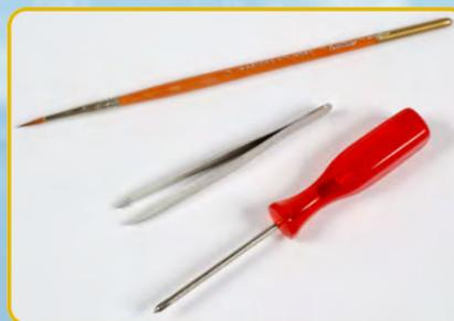
Per il montaggio del servo sono sufficienti un piccolo cacciavite a stella, una pinzetta e un pennellino (sopra) e il piccolo tubetto di grasso (sotto), che ti servirà per lubrificare le ruote dentate del servo.
