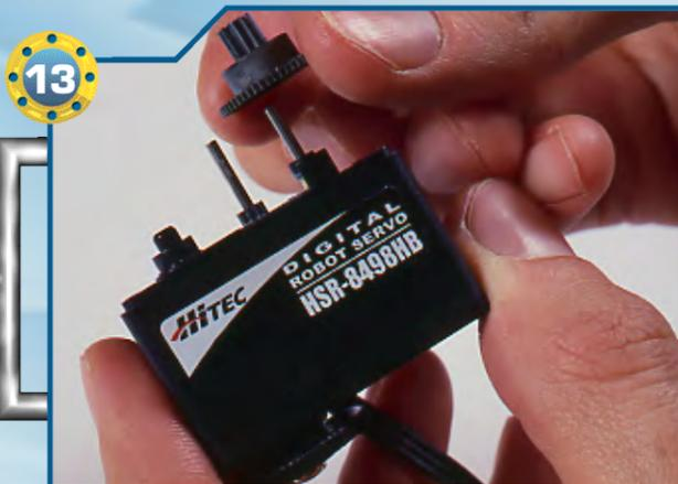
◀13▶ Infiliamo la ruota dentata numero 2 sul perno appena montato. La corona più larga della ruota dovrà essere orientata verso il servo, la più piccola verso l'esterno.
