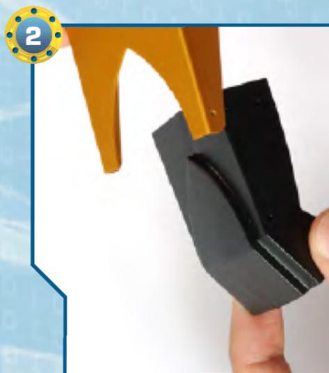
2 ▶ Posizioniamo l'intelaiatura metallica sui due elementi montati al passo precedente, facendo combaciare la sagomatura a forma di V dell'elemento in alluminio con quella corrispondente presente sulla mano, come mostrato in figura.
