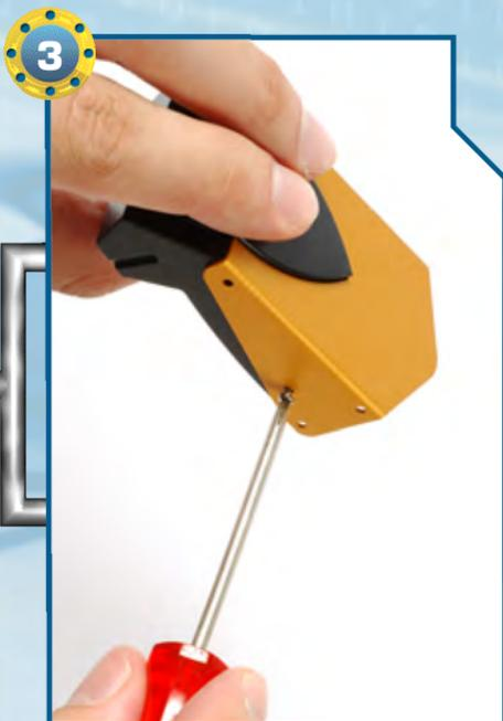
3 ▶ Utilizziamo ora le quattro viti di tipo T-2 da 2x5 mm per fissare gli elementi, senza forzarle eccessivamente per non 'spanare' i fori presenti sui pezzi.
