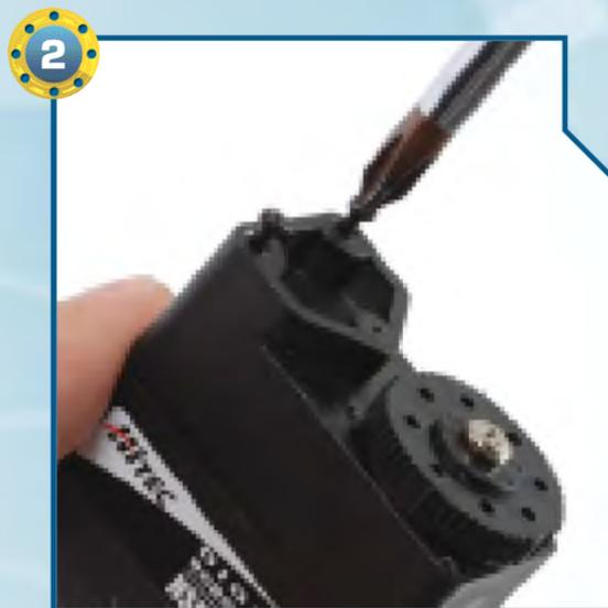
2 Allentiamo le due viti di tipo T-2 da 2x26 mm (nere) presenti sul medesimo lato del servomotore. È sufficiente svitare le viti di pochi millimetri, come mostrato nell'immagine qui sopra.
