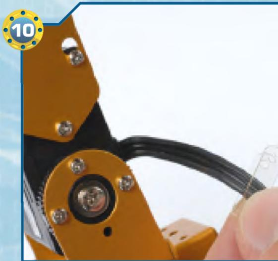
◀10▶ Recuperiamo una delle fascette in plastica per il fissaggio dei cavi e avvolgiamola intorno al filo che fuoriesce dal servomotore, come mostrato in figura.
