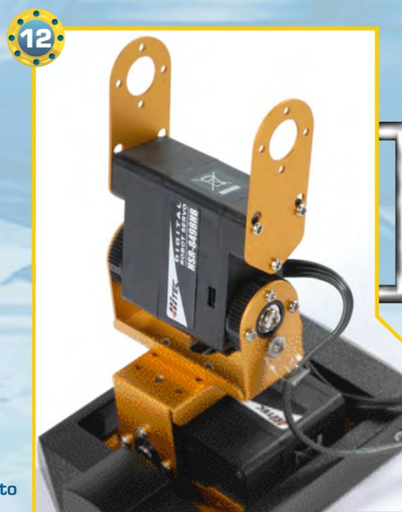
◀12▶ Ecco come appare RoboArm dopo l'assemblaggio del secondo servomotore. Con l'aggiunta del nuovo servo, il braccio ha guadagnato un ulteriore grado di libertà.
