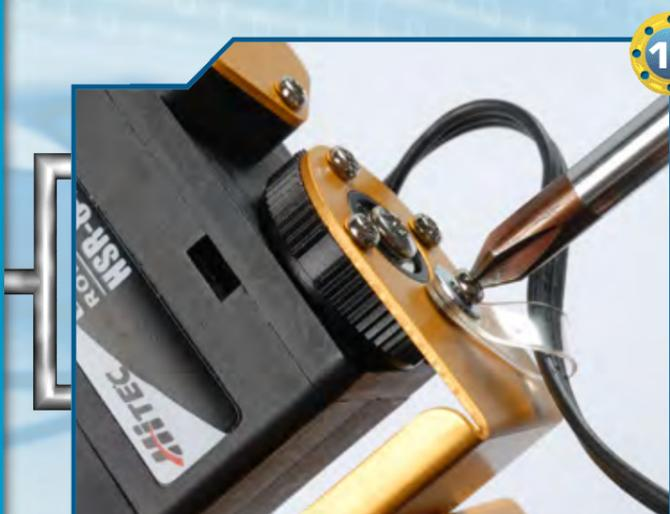
◀11▶ Serriamo una vite di tipo T-2 da 2x4 mm nel foro lasciato libero precedentemente, sistemando una rondella da 6x2,2x0,5 mm tra la vite e la fascetta di fissaggio in plastica.
