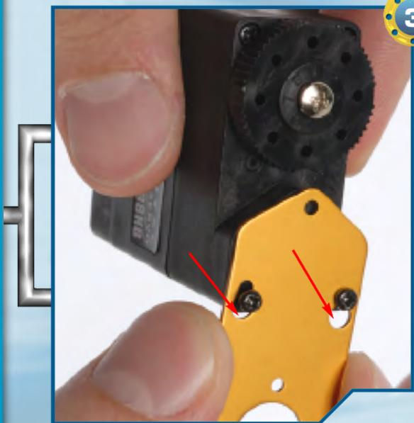
3 Montiamo ora una squadretta di alluminio dalla forma a I sul servo, orientando gli elementi come in figura. Facciamo passare le estremità superiori delle due viti nei fori larghi indicati dalle frecce, quindi allineiamo la sagomatura della squadretta con quella in plastica del servomotore.
