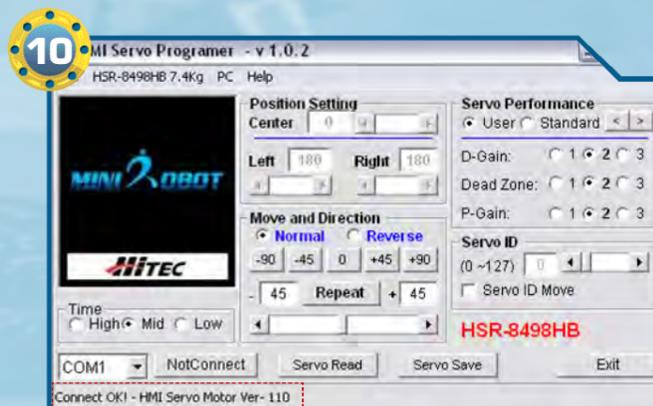
◀10▶ Clicchiamo sul pulsante 'Connect' per avviare la connessione con il servo. Se la connessione dovesse fallire, ricontrolliamo tutti i cablaggi. Sul lato inferiore sinistro della finestra dell'applicazione comparirà un messaggio per indicare l'avvenuta connessione con il servo.
