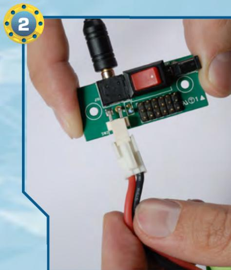
2 Recuperiamo ora il pacco batterie e inseriamo il suo connettore in quello presente sulla scheda PC Servo Control. Per svolgere correttamente le operazioni mostrate negli step successivi, il pacco batterie dovrà essere carico. Le operazioni di ricarica sono state presentate nel fascicolo numero 17.
