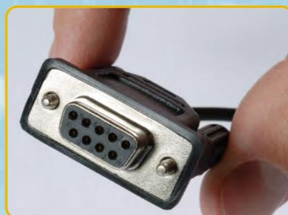
Una delle due estremità del cavo seriale è dotata di un connettore seriale RS-232 da collegare al computer.
