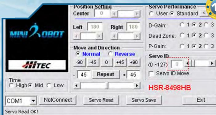
◀11▶ Clicchiamo ora sul pulsante 'Servo Read'. Tramite questa operazione, il programma legge la configurazione salvata nel servomotore. Come si può notare dalla schermata accanto, l'ID del servo impostato di default ha un valore pari a '1'.
