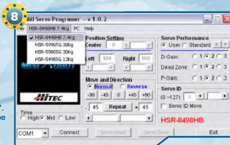
8 Non ci resta che settare anche il tipo di servomotore utilizzato, ossia 'HSR-8498HB'. Anche questa opzione dovrebbe già essere impostata come default, ma verificiamolo comunque, per sicurezza.
