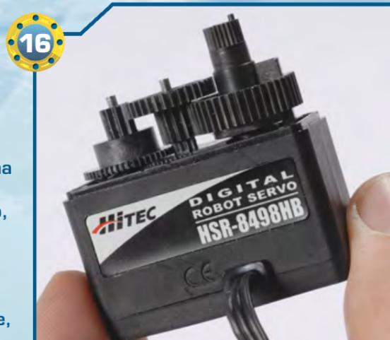
◀16▶ Inseriamo anche l'ultima ruota dentata, la numero 3, sul perno metallico più lungo, orientando la corona più stretta della ruota dentata verso il servomotore. Applichiamo anche un po' di grasso sulle ruote dentate, per lubrificarle.
