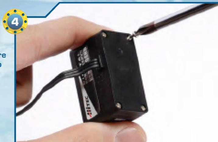
4 Fissiamo la base inferiore del servo utilizzando quattro viti di tipo T-2 da 2x12 mm.
