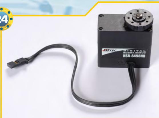
◀24▶ Ecco come appare il servomotore di tipo C una volta assemblato.
