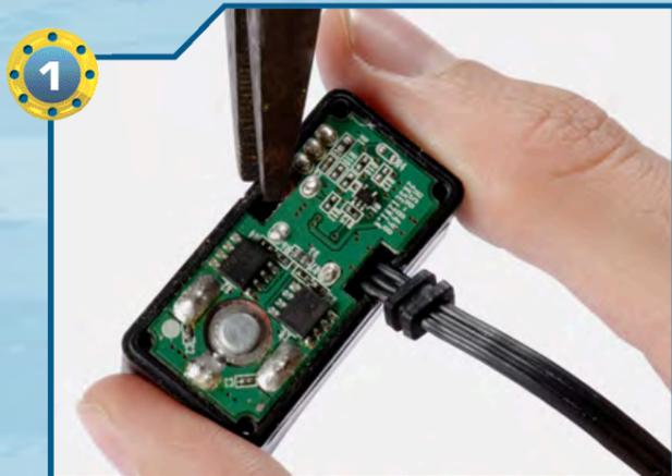
1 Come al solito procediamo alla rimozione delle due linguette di plastica dal motore elettrico del servomotore, utilizzando una pinza a becco stretto.
