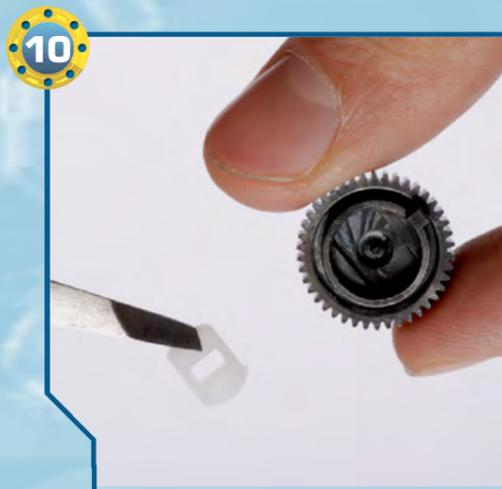
◀10▶ Aiutandoci con una pinzetta inseriamo il sostegno per il potenziometro all'interno della ruota dentata numero 4, orientandolo come in figura.
