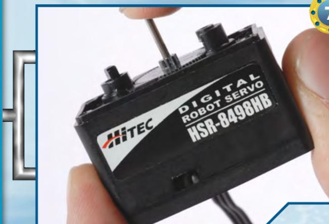
◀7▶ Inseriamo il perno più lungo, quello da 1,6x14 mm, nel foro circolare presente sulla ruota dentata inserita in precedenza. Premiamo con decisione per inserire il perno.
