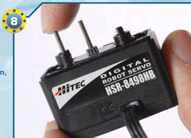
◀8▶ Inseriamo anche il perno più corto, quello da 1,6x9 mm, nel foro presente sul pignone del servomotore.
