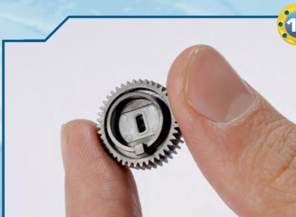
◀11▶ Per fissare il sostegno esercitiamo una leggera pressione. L'immagine mostra il sostegno correttamente posizionato all'interno della ruota dentata.
