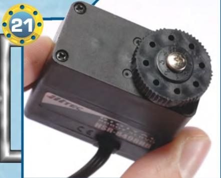
◀21▶ Una volta posizionata la squadretta fissiamola al servomotore con la vite di tipo T-2 da 2,6x6 mm.
