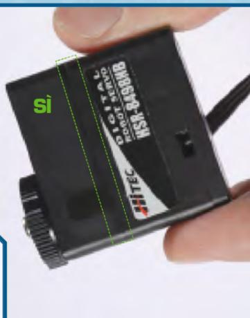
◀22▶ Controlliamo che la base superiore del servo sia montata correttamente, verificando che sia perfettamente adiacente al corpo centrale del motore.
