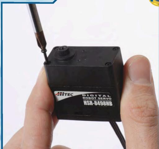
◀19▶ Fissiamo la base del servo serrando le quattro viti nere di tipo T-2 da 2x21 mm.
