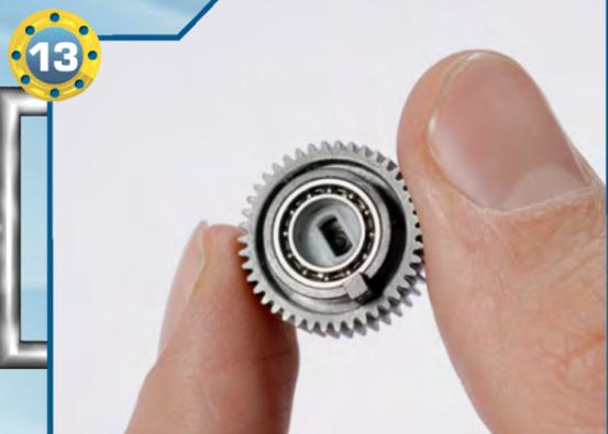
◀13▶ La ruota dentata numero 4, dopo il montaggio del sostegno per il potenziometro e del cuscinetto, è pronta per essere inserita nel servo.
