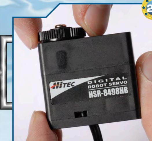
◀23▶ Possiamo verificare il corretto funzionamento del servomotore ruotando manualmente la squadretta circolare.
