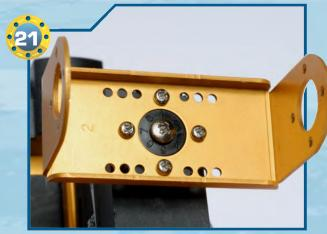
**<21**▶Posizioniamo la squadretta metallica a U, rimossa al passo 5, sulla squadretta circolare del servo di tipo C. Orientiamo le tacche numerate della squadretta come nell'immagine e fissiamo quest'ultima con quattro viti di tipo T-2 da 2x4 mm.
