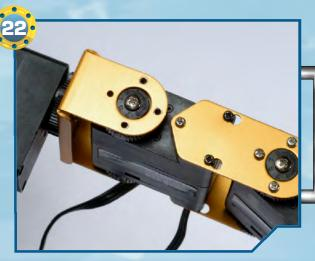
**<22**▶Colleghiamo le due 'metà' di RoboArm, inserendo il servomotore di tipo A (montato all'estremità superiore di RoboArm) alla squadretta metallica a U (montata sul servomotore di tipo C). Le tacche numeriche della squadretta circolare di tipo 1 vanno orientate come nell'immagine.
