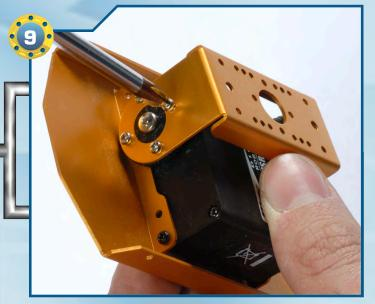
**49**▶P rocediamo ora con la rimozione delle quattro viti di tipo T-2 da 2x4 mm che fissano la squadretta metallica alla squadretta circolare di tipo 3 del servomotore montato sulla base di RoboArm.
