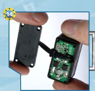
**114**▶Richiudiamo il servo con la sua base inferiore in plastica. Per il momento non fissiamo la base con le relative viti.
