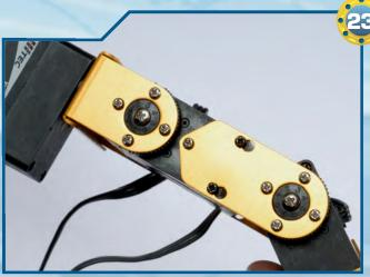
**423**▶Fissiamo la squadretta circolare di tipo 1 con quattro viti di tipo T-2 da 2x4 mm.
