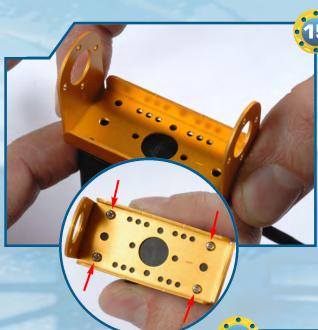
**◆15▶**Collochiamo la squadretta metallica rimossa al passo 11 sulla base inferiore del servo, come mostrato nell'immagine, e serriamo le 4 viti di tipo T-2 da 2x12 mm nei fori indicati dalle frecce.
