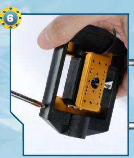
**√6** Togliamo anche le quattro viti di tipo M da 2x4 mm che fissano la copertura in plastica del piede.
