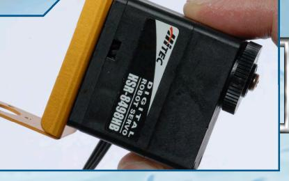
**<17** Colleghiamo il blocco servomotore-squadretta, appena montato, sulla base di RoboArm. Orientiamo le tacche numeriche della squadretta circolare di tipo 1 del servomotore di tipo B come mostrato nell'immagine: la tacca numero '7' va rivolta verso la base di RoboArm.
