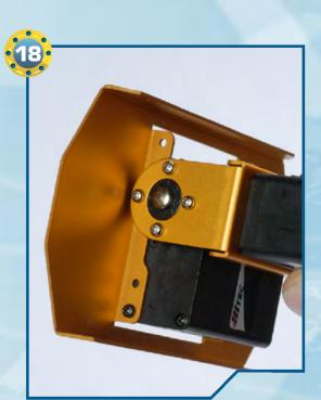
**118** Fissiamo la squadretta circolare del servomotore alla squadretta metallica, utilizzando quattro viti di tipo T-2 da 2x4 mm.
