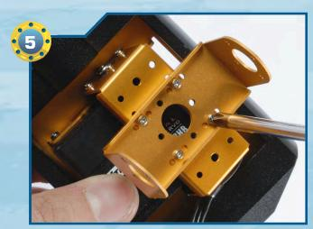
**√5**▶Rimuoviamo le quattro viti di tipo M da 2x4 mm che fissano le due squadrette metalliche a U montate sulla base di RoboArm.
