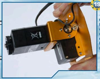
**119** Serriamo quattro viti di tipo T-2 da 2x4 mm anche sul lato opposto. Prima di serrare la vite del foro inferiore, montiamo una fascetta trasparente e una rondella da 6x2,2x0,5 mm per bloccare il cavo del servo, come già mostrato più volte.
