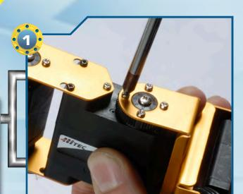
**◆1** • Rimuoviamo le quattro viti di tipo T-2 da 2x4 mm che fissano la squadretta circolare di tipo 1 del servomotore centrale (di tipo A) alla squadretta metallica a U.
