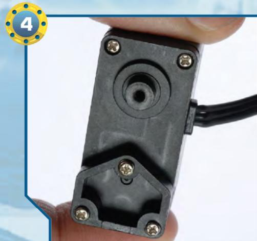
4 Fissiamo il servomotore alla base serrando le relative viti (2 viti di tipo T-2 da 2x12 mm, 2 viti di tipo T-2 da 2x18 mm e una vite di tipo T-2 da 2x5 mm), come indicato negli step di montaggio 2, 3 e 4 presenti a pagina 5 del fascicolo 13.
