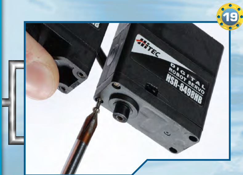
◀19▶ Togliamo le ultime due viti rimaste sulla copertura inferiore del servomotore di tipo B.
