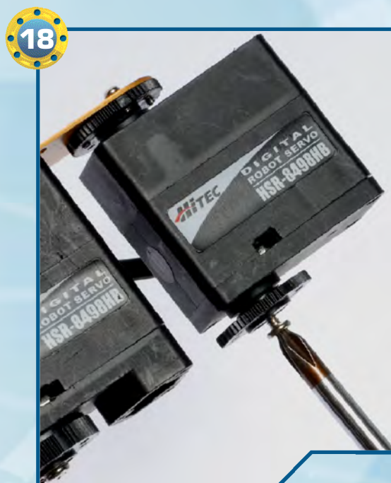
◀18▶ Rimuoviamo la squadretta circolare di tipo 2 dal servomotore di tipo B: per compiere questa operazione dobbiamo per prima cosa rimuovere la vite di tipo T-2 da 2,6x6 mm.
