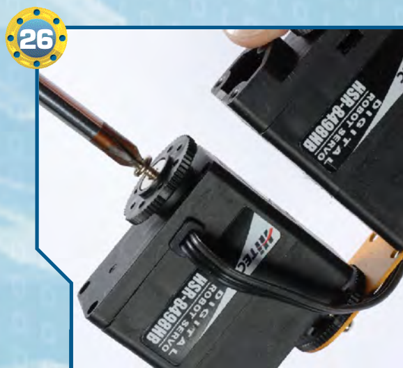
◀26▶ Fissiamo la squadretta con una vite di tipo T-2 da 2,6x6 mm. Ricordiamoci, prima di inserire la vite, di posizionare anche la rondella da 7,6x2,8x0,5 mm.
