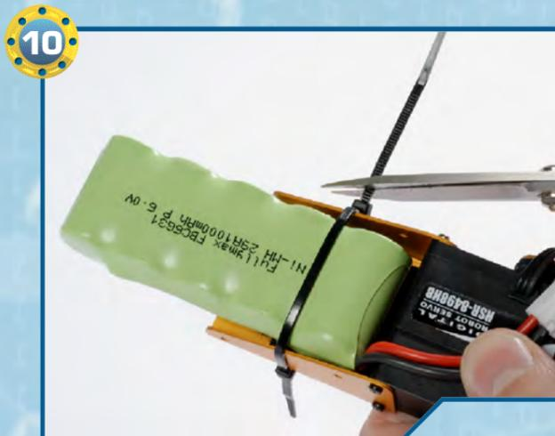
◀10▶ Utilizziamo le due fascette assemblate nel passo precedente e usiamole per fissare il pacco batterie alla coda. Ritagliamo l'eccedenza delle due fascette con una forbice.
