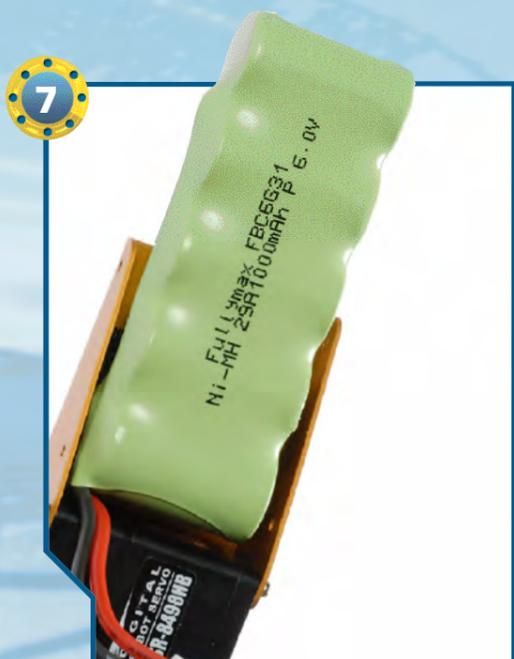
◀7▶ Collochiamo il pacco batterie sulla coda di RoboSnake, in modo che le due strisce di velcro combacino.
