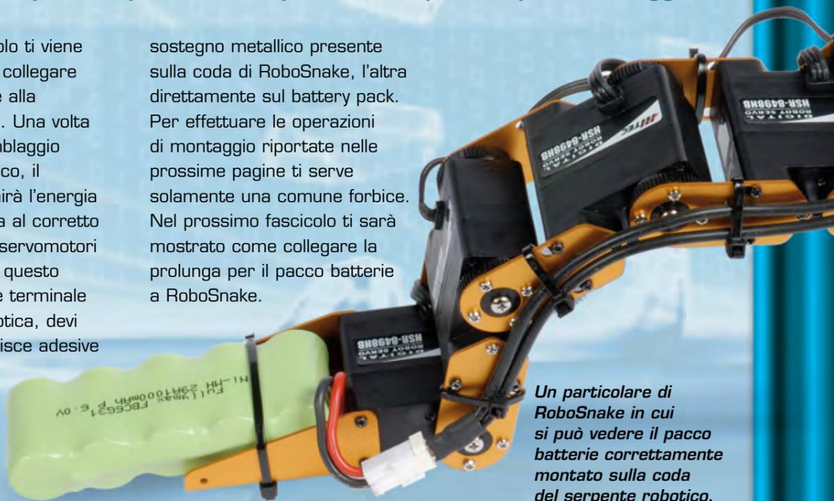
*Un particolare di RoboSnake in cui si può vedere il pacco batterie correttamente montato sulla coda del serpente robotico.*
