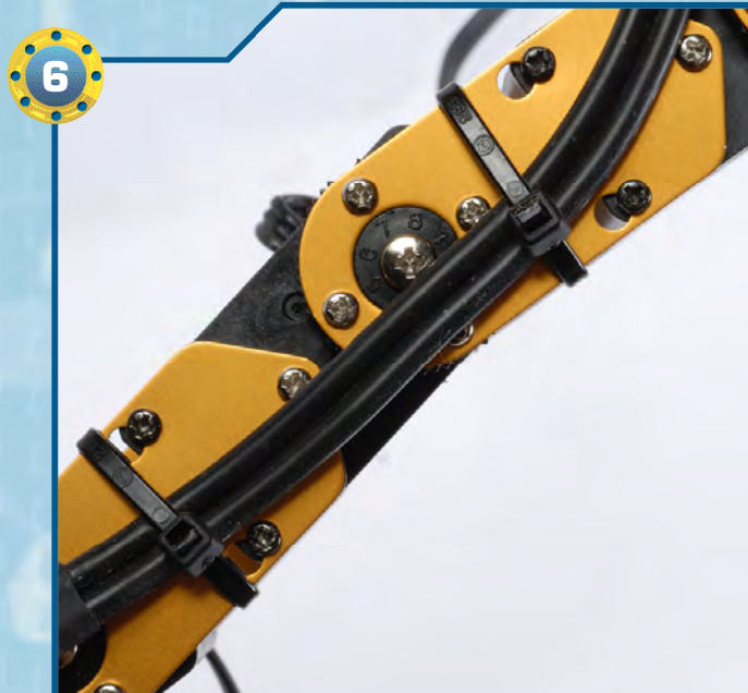
6 Poniamo un'altra fascetta in corrispondenza della successiva squadretta metallica a I.
