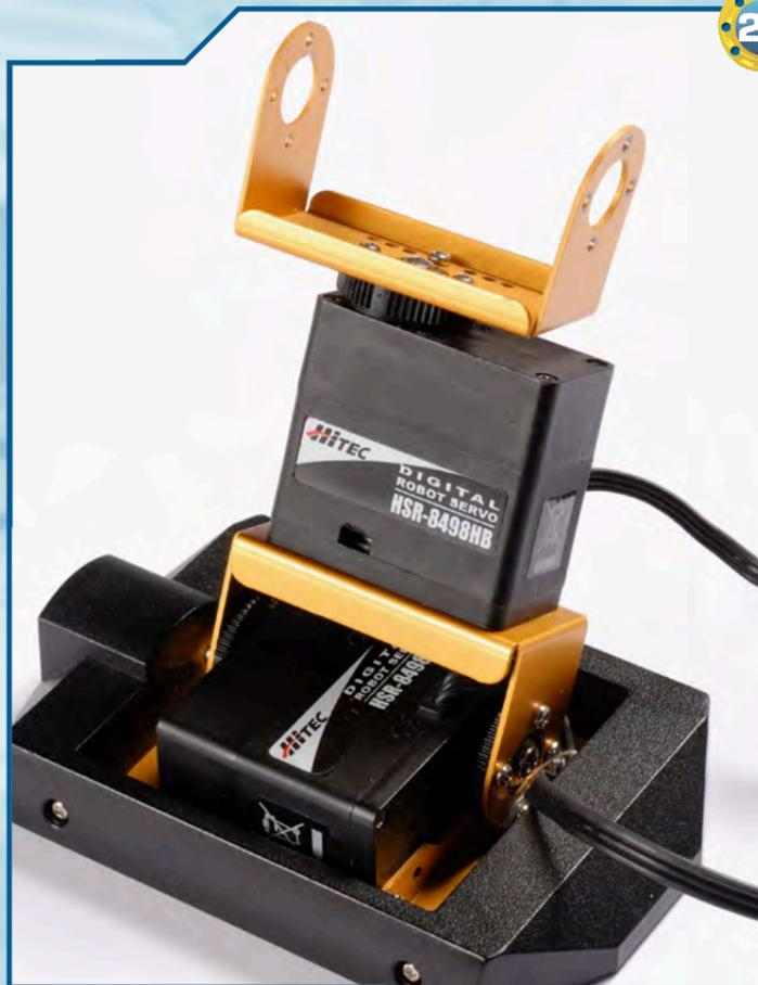
**22** Procediamo ora con lo smontaggio della base di appoggio di RoboArm. Questa operazione ci permetterà di recuperare due servomotori, uno di tipo B e uno di tipo C.
