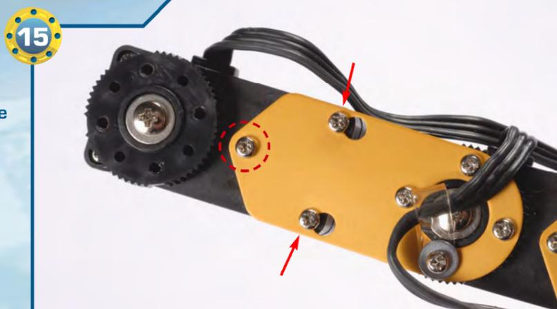
◀15▶ Rimuoviamo la vite di tipo T-2 da 2x5 mm (cerchiata in rosso) e allentiamo di alcuni millimetri le due viti di tipo T-2 da 2x18 mm (indicate dalle frecce).
