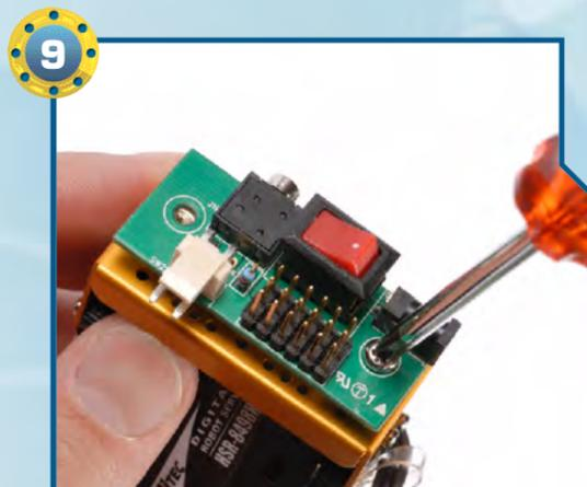
◀9▶ Rimuoviamo le due viti che fissano la scheda PC Servo Control alla squadretta metallica a U.
