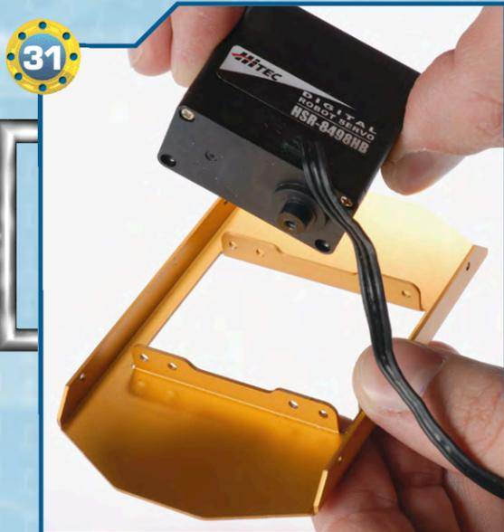
**31** Separiamo il servomotore di tipo B dall'intelaiatura metallica del piede. Possiamo quindi reinserire sul servo le viti tolte in precedenza.
