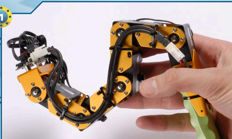
◀1▶ Iniziamo con lo smontaggio di RoboSnake, recuperando, oltre ai cinque servomotori, anche gli altri elementi che compongono il robot (squadrette, viti, ecc.).
