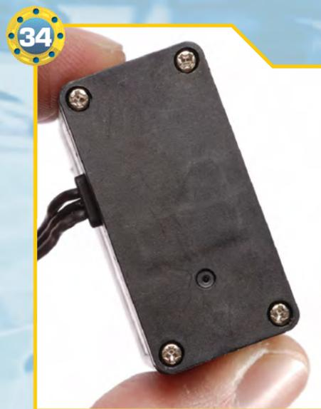
**34** Reinseriamo sulla base del servomotore di tipo C le quattro viti di tipo T-2 da 2x12 mm tolte durante lo step 32.
