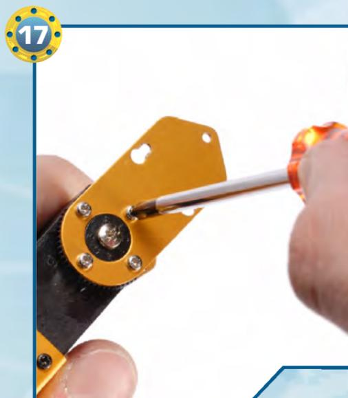
**17** Rimuoviamo le quattro viti di tipo T-2 da 2x4 mm che fissano una delle due squadrette metalliche a I sul servo di tipo B.
