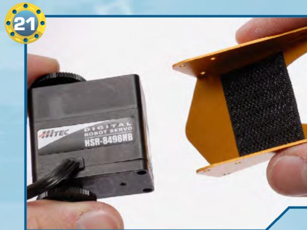
**21** Separiamo il servomotore di tipo B dall'intelaiatura metallica del polso. Al termine di questa operazione, reinseriamo sul servo le viti rimosse in precedenza.
