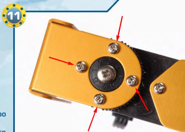
◀11▶ Proseguiamo con lo smontaggio di RoboSnake. Rimuoviamo le quattro viti di tipo T-2 da 2x4 mm, indicate dalle frecce rosse nell'immagine a lato.
