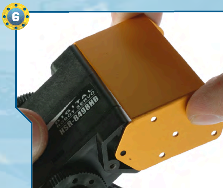
◀6▶ Inseriamo la squadretta di metallo sul servomotore di tipo A, come mostrato nell'immagine qui sopra.
