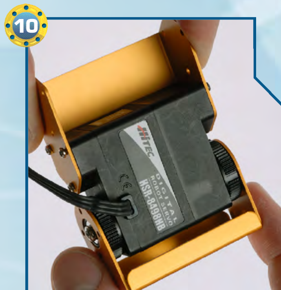
◀10▶ Inseriamo la squadretta di metallo sul servomotore di tipo A.
