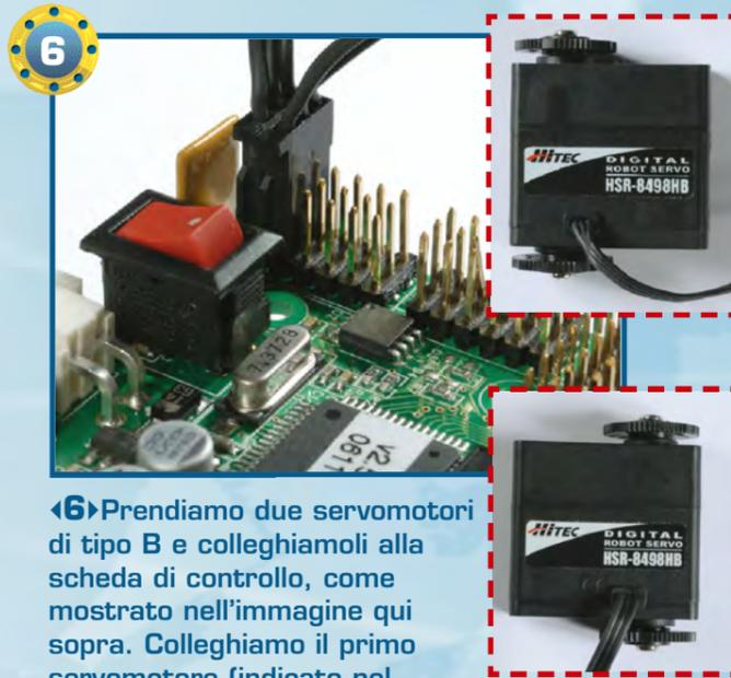
◀6▶ Prendiamo due servomotori di tipo B e colleghiamoli alla scheda di controllo, come mostrato nell'immagine qui sopra. Colleghiamo il primo servomotore (indicato nel riquadro tratteggiato in alto) al pin s0 e il secondo servomotore (nel riquadro tratteggiato in basso) al pin s1. Facciamo bene attenzione a collegare i connettori dei servo nella giusta direzione.
