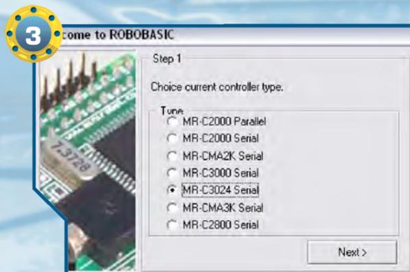
3 ▶ Avviamo il software RoboBasic. Al primo avvio del programma ci vengono chieste alcune informazioni. Per prima cosa dobbiamo specificare la scheda di controllo utilizzata: nel nostro caso è necessario selezionare MR-C3024.
