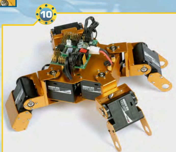
◀10▶ Ecco RoboSpider completo e dotato di pacco batterie. Fino a quando non sarà programmato, è consigliabile mantenere il pacco batterie scollegato dalla scheda e, in ogni caso, l'interruttore della scheda stessa nella posizione 'OFF'.
