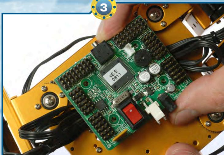
3 ▶ Posizioniamo la scheda di controllo MR-C3024 sui distanziatori, in modo che i quattro fori della scheda combacino con quelli dei distanziatori stessi e che il connettore per il cavo seriale sia rivolto verso la parte frontale di RoboSpider. Poi, prendiamo quattro viti di tipo M da 3x4 mm e fissiamo la scheda ai distanziatori.
