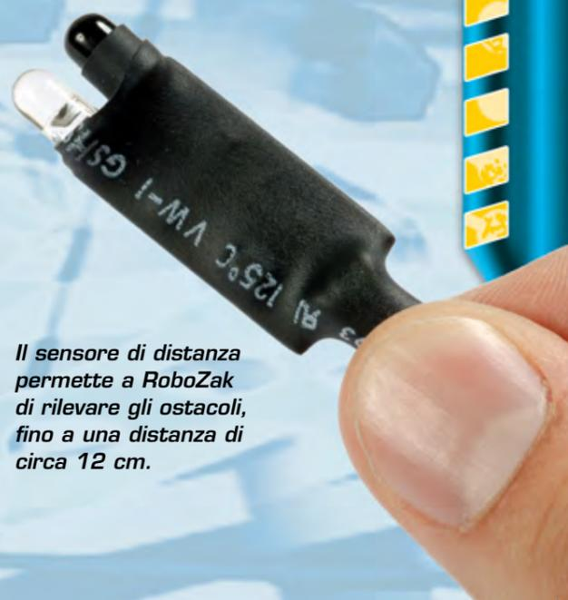
Il sensore di distanza permette a RoboZak di rilevare gli ostacoli, fino a una distanza di circa 12 cm.
