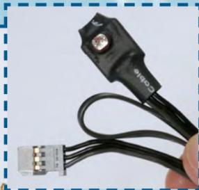
«1» Per testare l'esempio **SpiderLight.bas** dobbiamo collegare il sensore di luce (mostrato nel riquadro tratteggiato) alla porta **ADO** della scheda **MR-C3024**, orientando il connettore come nell'immagine a lato.
