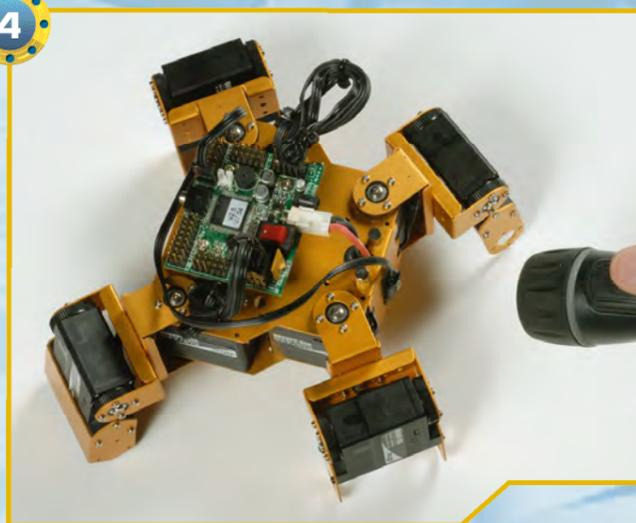
«4» Ora che il sensore è collegato, possiamo scaricare il programma sulla scheda di controllo e testarlo. Per 'azionare' RoboSpider, è sufficiente utilizzare una sorgente luminosa, come una piccola torcia elettrica. **NOTA: affinché il programma funzioni correttamente, è opportuno testarlo in una stanza non illuminata eccessivamente, altrimenti il sensore potrebbe essere azionato dalla luce ambientale.**
