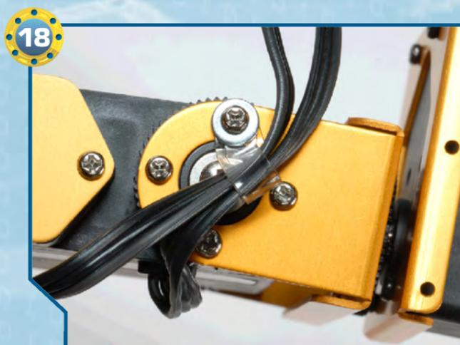
◀18▶ Serriamo quattro viti di tipo T-2 da 2x4 mm per fissare la squadretta circolare di tipo 4 del servo alla squadretta di metallo. Come al solito, utilizziamo una delle viti per fissare il cavo dei due servomotori, servendoci di una fascetta trasparente e di una rondella.
