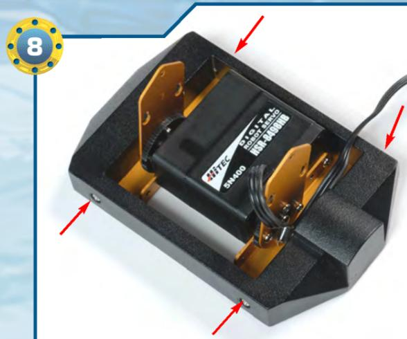
◀8▶ Fissiamo la copertura serrando quattro viti di tipo M da 2x4 mm nelle posizioni indicate dalle frecce rosse.
