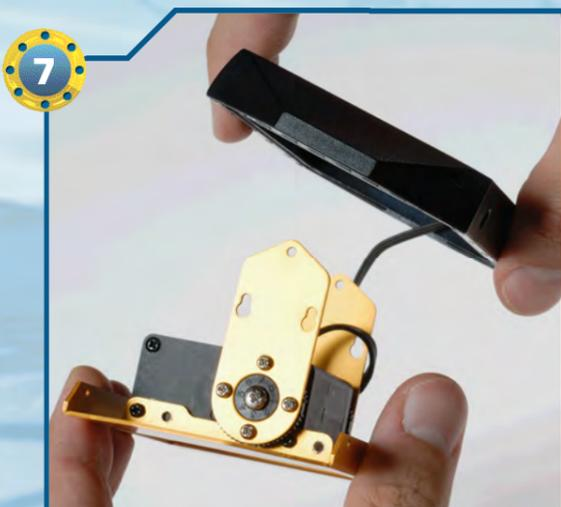
◀7▶ Inseriamo la copertura in plastica del piede sinistro sull'intelaiatura metallica.
