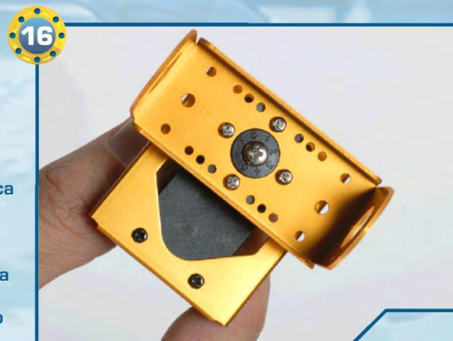
**16** Prendiamo una squadretta metallica a U, del tipo a 22 fori, e posizioniamola sopra la squadretta circolare di tipo 3 del servo, quindi fissiamola utilizzando quattro viti di tipo T-2 da 2x4 mm. Prima di inserire le viti, verificiamo che le tacche numeriche della squadretta siano orientate come nell'immagine accanto.
