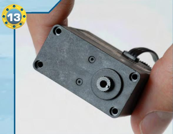
**13** Prendiamo un servomotore di tipo B con cavo uscente dal lato destro e rimuoviamo la squadretta circolare e le quattro viti di tipo T-2 da 2x21 mm.
