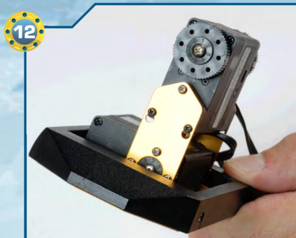
◀12▶ Ripetiamo la stessa operazione anche sulla base superiore del servo, reinserendo la due viti di tipo T-2 da 2x26 mm e la vite di tipo T-2 da 2x5 mm.
