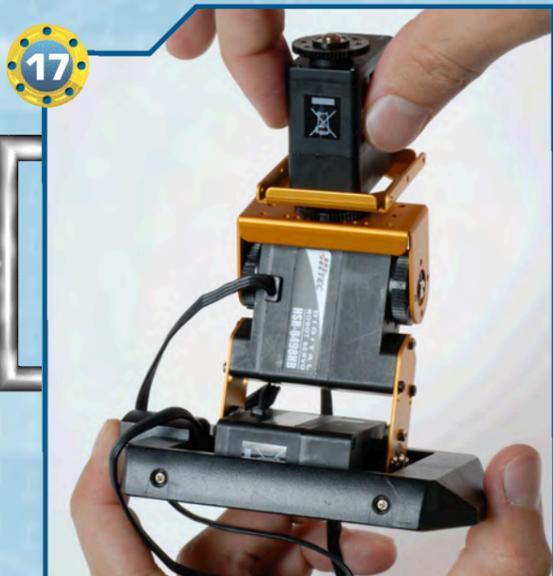
◀17▶ Agganciamo i due lati corti della squadretta metallica a U alle due squadrette circolari del servomotore di tipo A.
