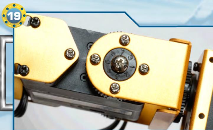
◀19▶ Fissiamo anche l'altro lato del servo, per mezzo di quattro viti di tipo T-2 da 2x4 mm.
