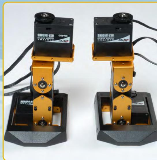
◀ Le due zampe di RoboPenguin a confronto. Nelle prossime pagine sono presenti le istruzioni di montaggio della zampa destra, composta da tre servomotori (due di tipo B e uno di tipo A).
