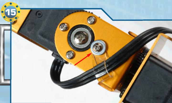
15 Serriamo quattro viti di tipo T-2 da 2x4 mm anche sul lato opposto, ricordandoci di inserire una fascetta e una rondella da 6x2,2x0,5 mm sulla vite indicata dalla freccia, fissando così il cavo del servomotore di tipo B.
