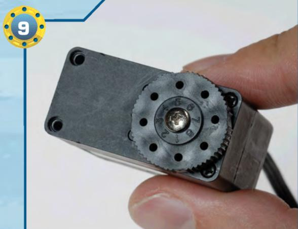
◀9▶ Prendiamo un servomotore di tipo C con il cavo uscente dal lato destro e rimuoviamo due viti di tipo T-2 da 2x21 mm dal lato superiore, come mostrato nell'immagine.
