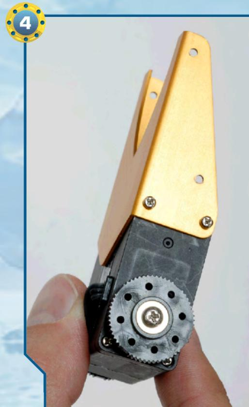
4 ▶ Completiamo l'assemblaggio della squadretta reinserendo anche le due viti di tipo T-2 da 2x12 mm.
