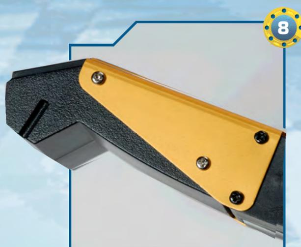
8 ▶ Ripetiamo l'operazione anche sul lato opposto, serrando altre due viti di tipo T-2 da 2x5 mm.
