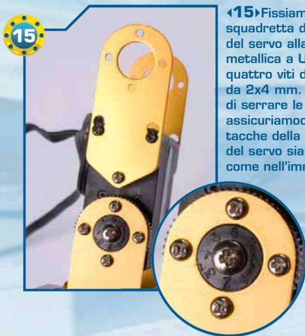
▶15▶ Fissiamo la squadretta di tipo 1 del servo alla squadretta metallica a U, utilizzando quattro viti di tipo T-2 da 2x4 mm. Prima di serrare le viti, assicuriamoci che le tacche della squadretta del servo siano orientate come nell'immagine.
