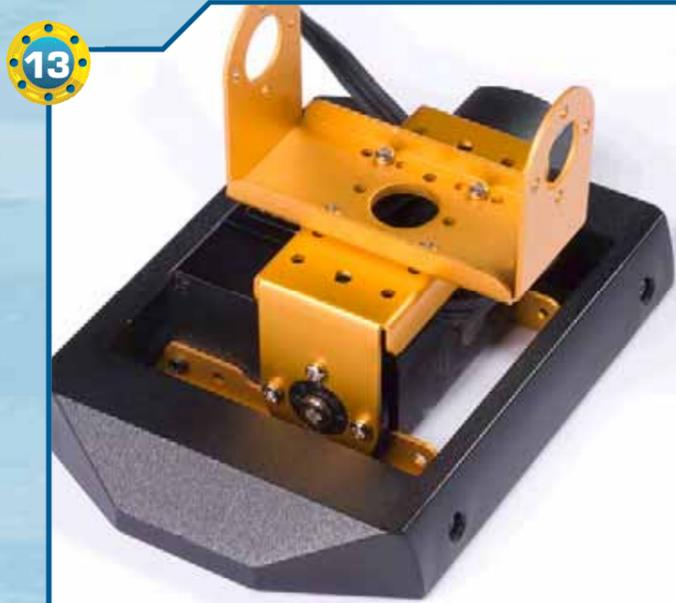
▶13▶ Riposizioniamo la copertura in plastica del piede e fissiamola reinserendo le quattro viti di tipo M da 2x4 mm.
