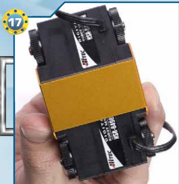
▶17▶Prendiamo ora due nuovi servomotori di tipo A (uno con cavo uscente dal lato destro e uno con cavo uscente dal lato sinistro) e collegiamoli utilizzando una squadretta di metallo a H, orientandoli come nell'immagine. Prima di inserire i servomotori nella squadretta, dobbiamo rimuovere tutte le viti presenti sulle torrette triangolari dei servo.
