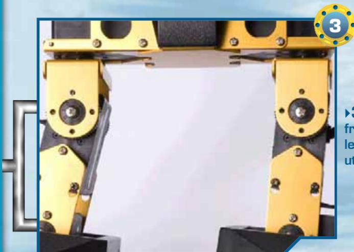
▶3▶ Agiamo dapprima sulla parte frontale del pinguino, rimuovendo le otto viti di tipo T-2 da 2x4 mm utilizzate per fissare le zampe.
