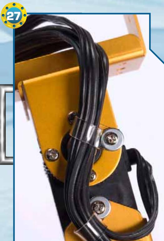
▶27▶ Infine, serriamo quattro viti di tipo T-2 sul lato opposto, inserendo su una di esse una squadretta di fissaggio per raggruppare i cavi di tutti e quattro i servomotori.
