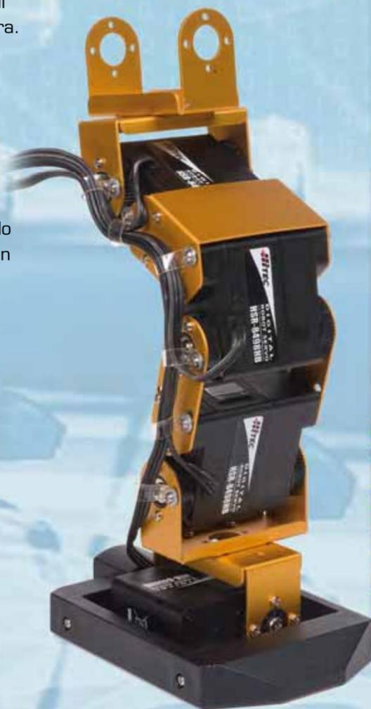
La prima gamba di RoboZak è costituita da quattro servo, tre di tipo A e uno di tipo B.
