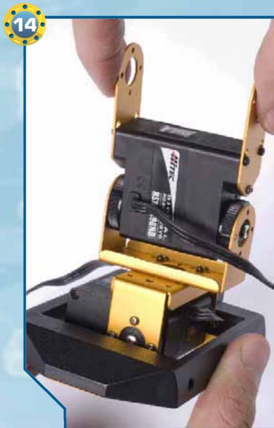
▶14▶ Prendiamo il servomotore di tipo A, montato in precedenza sulla zampa sinistra (con il cavo uscente dal lato sinistro) e colleghiamolo al piede destro. Facciamo riferimento all'immagine per orientare correttamente i diversi elementi.
