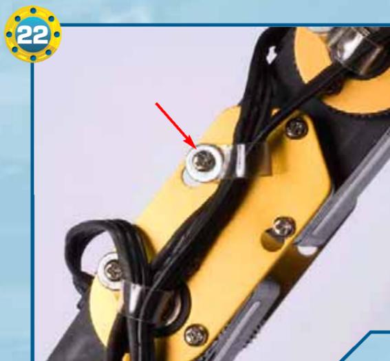
▶22▶ Serriamo quattro viti di tipo T-2 da 2x4 mm anche sul lato opposto, utilizzandone una per inserire una fascetta trasparente per fissare i cavi del servo. Rimuoviamo la vite di tipo T-2 da 2x18 mm (indicata dalla freccia rossa) e inseriamo su quest'ultima un'ulteriore fascetta per fissare i cavi dei due servomotori inferiori.
