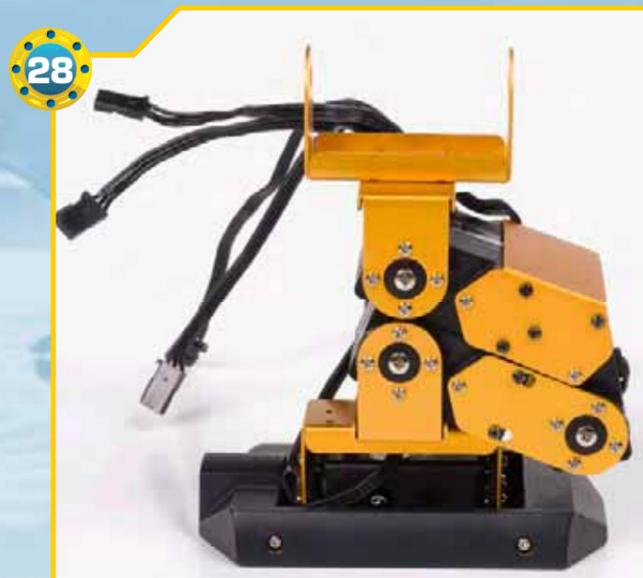
▶28▶ La gamba destra di RoboZak è assemblata. Se il montaggio è stato effettuato in modo corretto, dovremo riuscire a posizionare i servomotori come mostrato nell'immagine.
