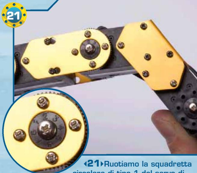
▶21▶ Ruotiamo la squadretta circolare di tipo 1 del servo di tipo A (quello posizionato nel ginocchio) in modo che le tacche numerate risultino orientate come nell'immagine, quindi fissiamola con quattro viti di tipo T-2 da 2x4 mm.
