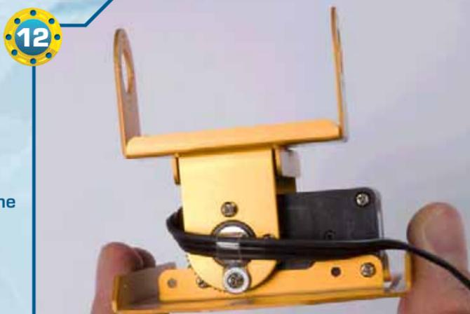
◀**12**▶ Serriamo quattro viti di tipo T-2 da 2x4 mm anche sul lato opposto, utilizzandone una per fissare il cavo del servo (come al solito utilizziamo una rondella e una fascetta trasparente).
