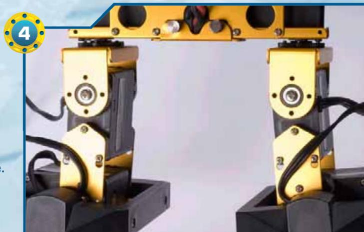
◀4▶ Analogamente, togliamo le otto viti di tipo T-2 da 2x4 mm presenti sulla parte posteriore delle zampe.
