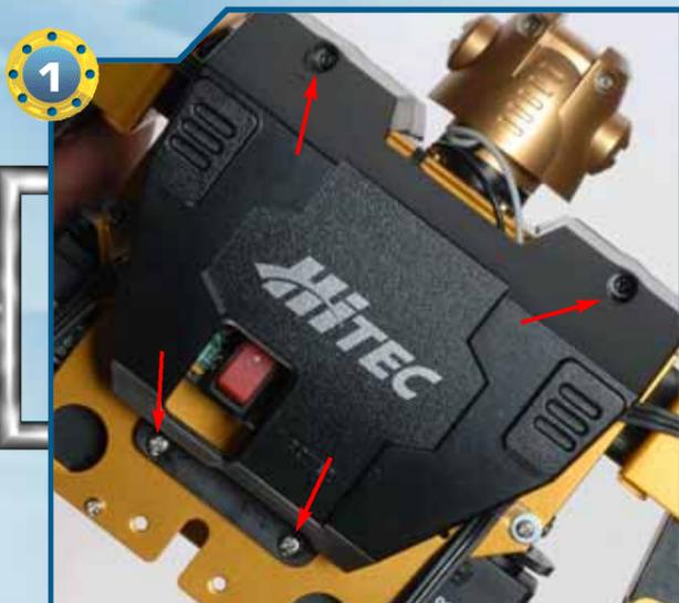
▶1▶ Per prima cosa rimuoviamo le quattro viti (indicate dalle frecce rosse) che fissano l'armatura in plastica sul dorso di RoboPenguin.
