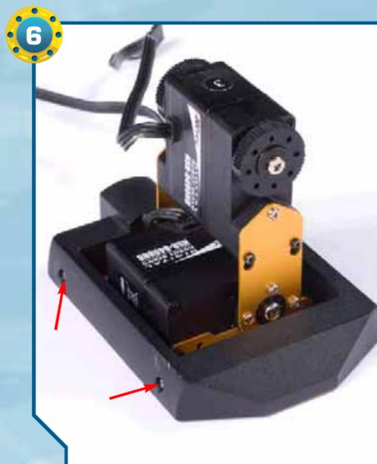
►6► Rimuoviamo le quattro viti di tipo M da 2x4 mm che fissano l'intelaiatura metallica all'elemento in plastica del piede destro di RoboPenguin (due viti sono indicate dalle frecce, mentre le altre sono sul lato opposto).
