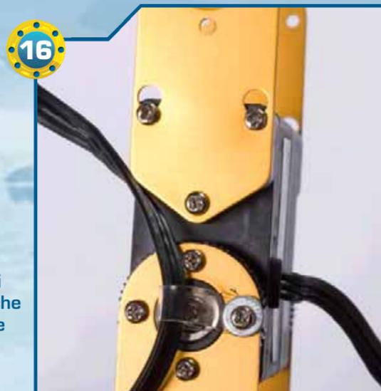
▶16▶ Serriamo quattro viti di tipo T-2 da 2x4 mm anche sull'altro lato, utilizzandone una per fissare il cavo del servomotore di tipo B (montato nel piede).
