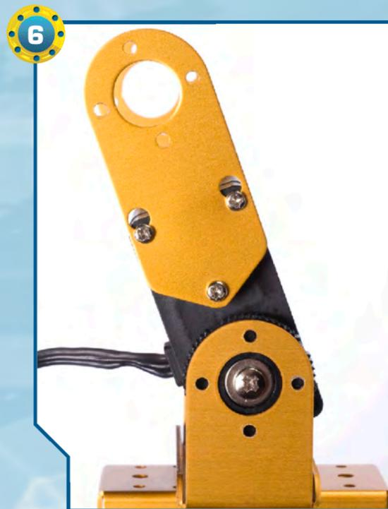
6 ▶ Prendiamo il servomotore di tipo A montato in precedenza nella zampa destra di RoboPenguin (con cavo uscente dal lato destro e sul quale sono collocate due squadrette di metallo a I) e agganciamolo sulla squadretta di metallo a U con 16 fori (la caviglia di RoboZak).
