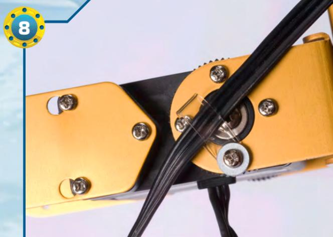
8 ▶ Serriamo quattro viti di tipo T-2 da 2x4 mm anche sull'altro lato, utilizzandone una per fissare il cavo del servomotore montato nel piede.
