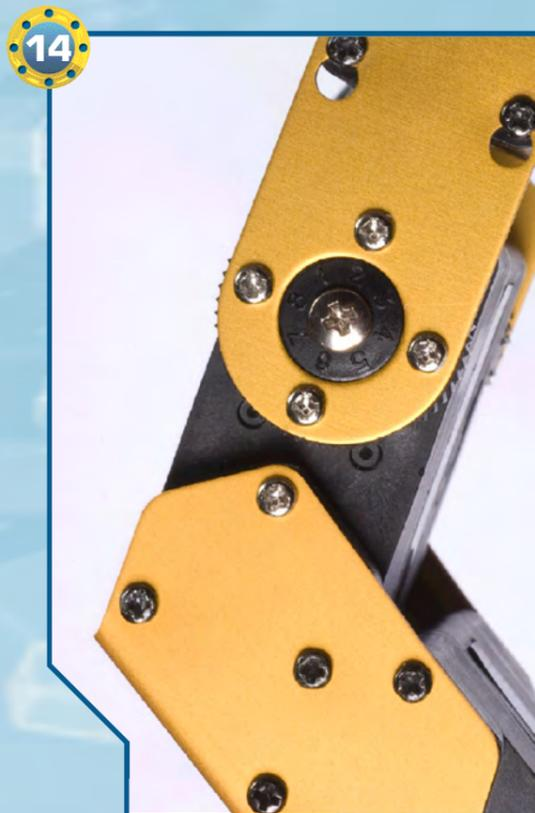
◀14▶ Ruotiamo la squadretta circolare di tipo 1 del servo di tipo A (quello posizionato nel ginocchio) in modo che le tacche numerate risultino orientate come nell'immagine, quindi fissiamola con quattro viti di tipo T-2 da 2x4 mm.
