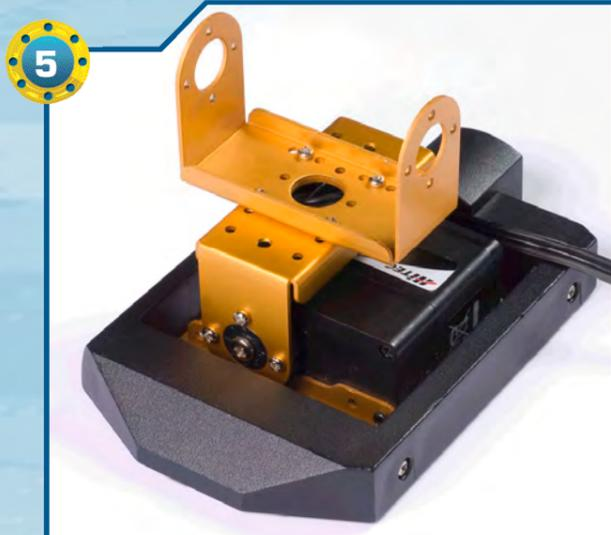
5 ▶ Posizioniamo la copertura in plastica sull'intelaiatura metallica del piede e utilizziamo quattro viti di tipo M da 2x4 mm per fissarla.
