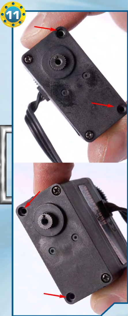
◀11▶ Prendiamo una coppia di servomotori di tipo B, uno con il cavo uscente dal lato sinistro (in basso nell'immagine) e uno con il cavo uscente dal lato destro (in alto nell'immagine). Rimuoviamo le due squadrette circolari di tipo 3 e, per ognuno dei due servo, togliamo la coppia di viti di tipo T-2 da 2x21 mm indicata dalle frecce.
