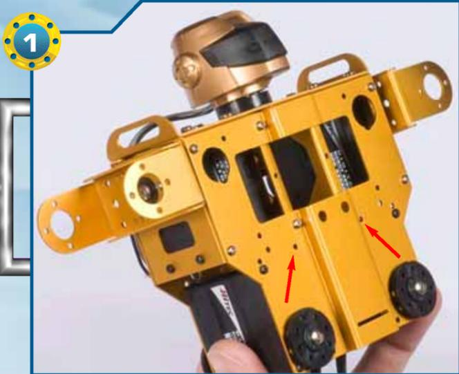
▶1▶ Accostiamo il tronco di RoboZak, costruito nello scorso fascicolo, all'armatura frontale in plastica. Nei due fori indicati dalle frecce, inseriremo successivamente una coppia di viti T-2 da 2x4 mm.
