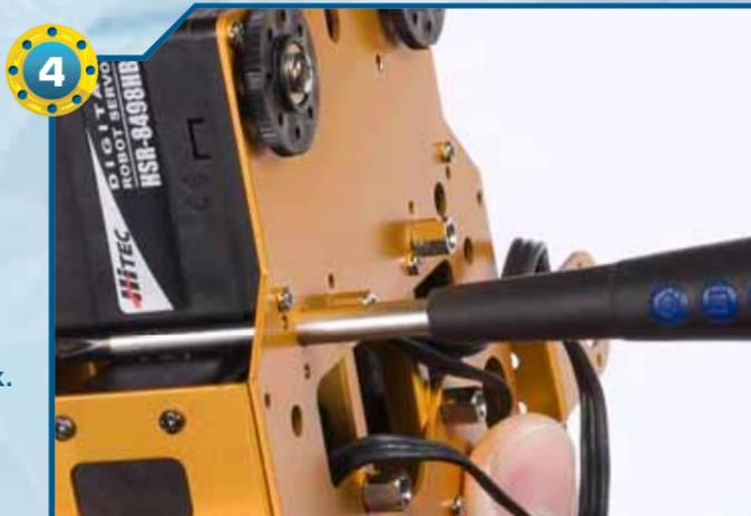
◀4▶ Ripetiamo l'operazione anche sull'altro foro, serrando una nuova vite di tipo T-2 da 2x4 mm. In questo modo abbiamo fissato la corazza alla piastra frontale di RoboZak.
