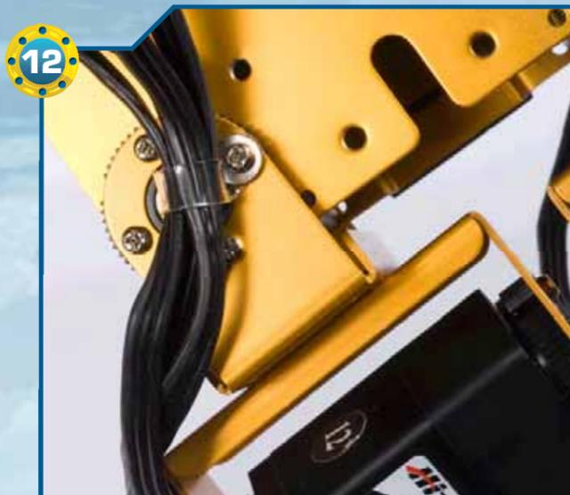
▶**12**▶ Serriamo quattro viti di tipo T-2 da 2x4 mm anche sul lato opposto, inserendo su una di esse una fascetta trasparente e una rondella da 6x2,2x0,5 mm per fissare i cavi dei quattro servomotori presenti nella gamba sinistra.
