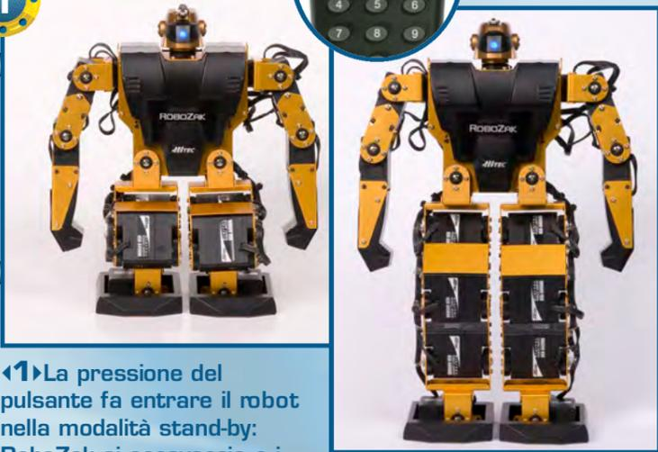
«1» La pressione del pulsante fa entrare il robot nella modalità stand-by: RoboZak si accovaccia e i motori vengono disattivati. Premendo nuovamente il pulsante i motori vengono riattivati e l'umanoide si riporta in posizione eretta.
