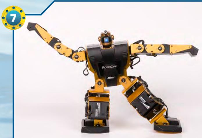
◀7▶ Dopo un secondo viene invocata la routine 'right\_attack' del programma 'template.bas' (comando ACTION 20). RoboZak effettua un attacco laterale a destra.
