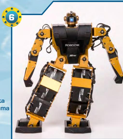
◀6▶ Dopo un secondo viene invocata la routine 'right\_shift' del programma 'template.bas' (comando ACTION 13). RoboZak effettua un passo laterale verso destra.
