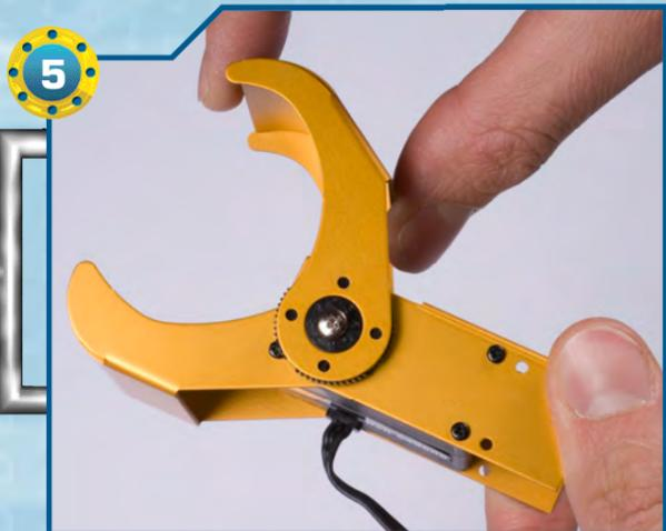
◀5▶ Prendiamo la struttura metallica superiore della mano e agganciamola alle due squadrette circolari del servomotore.
