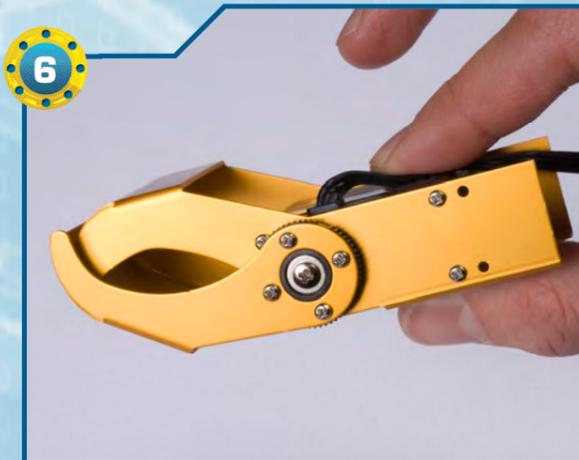
◀6▶ Serriamo quattro viti di tipo T-2 da 2x4 mm per fissare la struttura metallica alla squadretta circolare di tipo 4 del servo.
