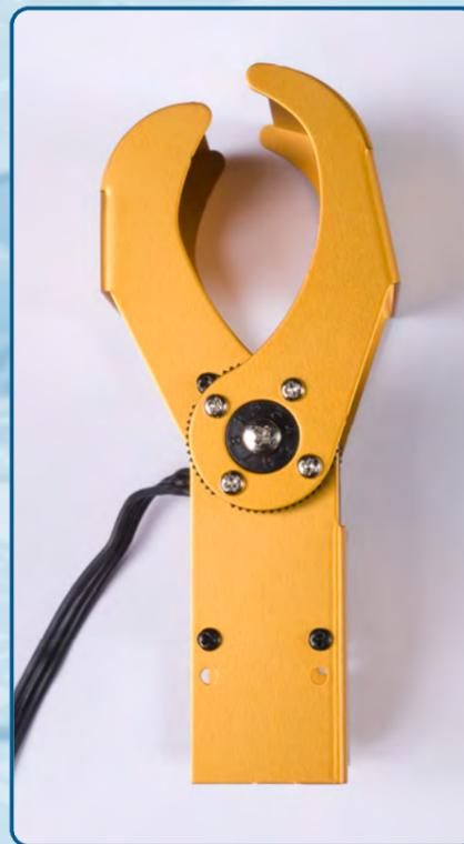
◀ La mano di RoboZak è composta da due elementi in alluminio anodizzato (inferiore e superiore) e da un servomotore di tipo B.
