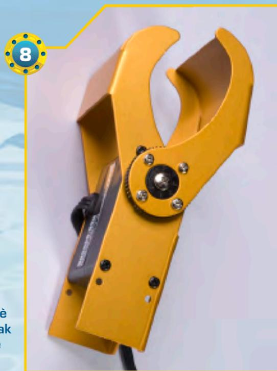
◀8▶ L'assemblaggio della mano destra è completato. La collegheremo a RoboZak solo quando avremo completato anche quella sinistra.
