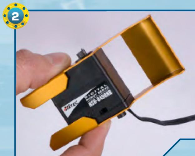
2 Inseriamo il servo nella struttura metallica inferiore della mano, orientandolo come nell'immagine. I pignoni del servo devono uscire dai due fori laterali della struttura metallica.
