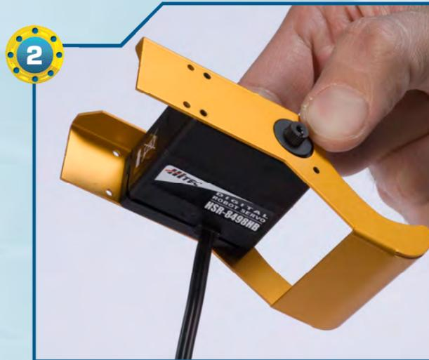
2 ▶ Inseriamo il servo nella struttura metallica inferiore della mano, orientandolo come nell'immagine. I pignoni del servo devono uscire dai due fori laterali della struttura metallica.
