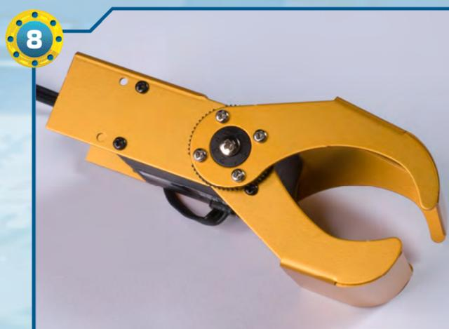
8 ▶ L'assemblaggio della mano sinistra è completato. Vediamo ora come montare le due mani sul robot.
