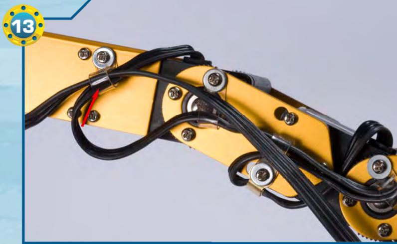
◀13▶Reinseriamo anche le due viti di tipo T-2 da 2x12 mm sull'altro lato del servo. Su una delle due viti inseriamo una fascetta trasparente e una rondella da 6x2,2x0,5 mm: con la fascetta blocchiamo i cavi dei due servomotori, come mostrato nell'immagine.
