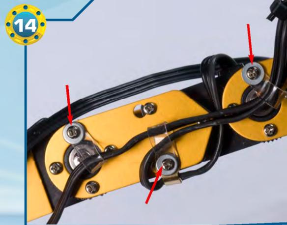
◀14▶Rimuoviamo le tre viti indicate dalle frecce: dovremo far passare il cavo del servomotore della mano nelle rispettive fascette trasparenti.
