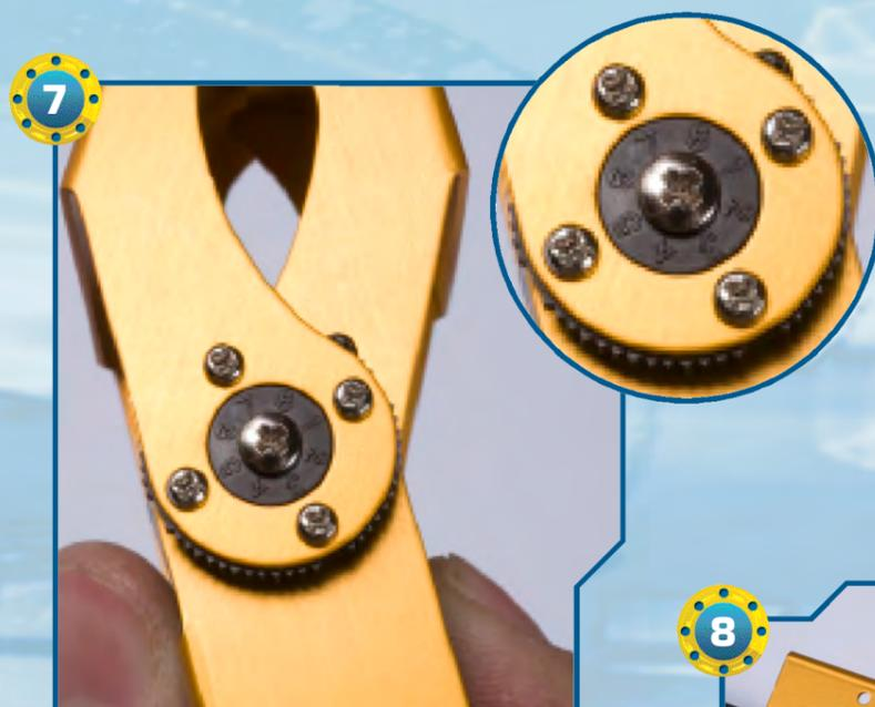
7 ▶ Fissiamo anche la squadretta di tipo 3 con quattro viti di tipo T-2 da 2x4 mm, orientando le tacche numeriche come indicato nell'immagine.
