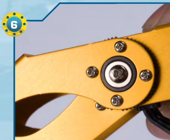
6 ▶ Serbiamo quattro viti di tipo T-2 da 2x4 mm per fissare la struttura metallica alla squadretta circolare tipo 4 del servo.
