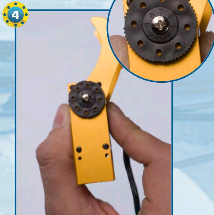
4 ▶ Reinseriamo le viti anche sull'altro lato del servo e posizioniamo la squadretta circolare di tipo 3: prima di serrare la vite di tipo T-2 da 2,6x6 mm, orientiamo le tacche numeriche della squadretta come mostrato nel tondo.
