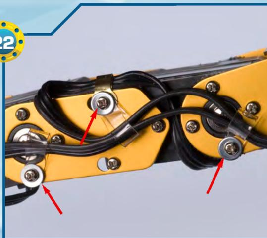
◀22▶Rimuoviamo le tre viti indicate dalle frecce: dovremo far passare il cavo del servomotore della mano nelle rispettive fascette trasparenti.
