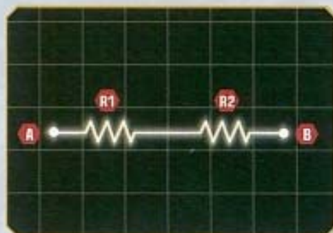
↻ Nella configurazione in serie (sopra) si sommano i valori di resistenza, in quella in parallelo (sotto), invece, si sommano i valori di conduttanza.
