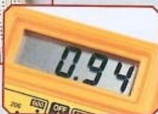
Una volta che abbiamo escluso il tester dal circuito e lo abbiamo sostituito con il filo elettrico procediamo con la misura della **caduta di tensione**. Ricordando ciò che abbiamo sperimentato nei fascicoli precedenti, impostiamo il tester per la misurazione di un voltaggio in corrente continua e portiamo le sonde a contatto con i reofori del resistore. Il tester ci restituisce una misura di **4,39 V**.
