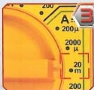
Impostiamo il tester per la misura di intensità di corrente con correnti continue, come mostrato in figura. Nel nostro caso abbiamo deciso di utilizzare una scala di 20 mA.
