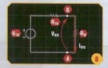
Il nuovo resistore inserito all'intero del circuito equivalente di Thévenin della rete elettrica iniziale.
