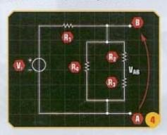
C Abbiamo dimensionato il resistore dell'equivalente Thévenin del circuito iniziale. Per il caso preso in considerazione il valore calcolato è di 2,353 kΩ.
