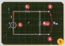
In basso a sinistra, in figura 4, la ridisposizione dei componenti del circuito iniziale che evidenzia come la differenza di potenziale V<sub>AB</sub> tra i punti A e B corrisponda alla caduta di tensione sul blocco formato dai resistori R<sub>2</sub>, R<sub>3</sub>, R<sub>4</sub>. In alto, in figura 5, il circuito ottenuto dopo aver sostituito i tre resistori R<sub>2</sub>, R<sub>3</sub>, R<sub>4</sub> con la resistenza equivalente R<sub>234</sub> su cui cade V<sub>AB</sub>.
