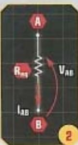
vero e proprio, sostituiamo a  $R_1$  e  $R_2$  un unico resistore  $R_{eq}$  (come nel circuito di **figura 2**) avente resistenza equivalente alla somma di entrambi. Il valore del resistore equivalente sarà quindi pari a  $50 \Omega$ , calcolato con la formula:
