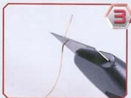
Aiutandoti con il cutter o il cacciavite, rimuovi la smaltatura del filo dai terminali della bobina. Per verificare che l'operazione sia stata svolta correttamente, puoi utilizzare il tester configurandolo per la misura delle resistenze: poni le due sonde a contatto con i due estremi del filo e se la resistenza misurata è 0 ohm (o prossima a questo valore), allora la 'pulitura' è andata a buon fine. Diversamente, ripeti l'operazione.
