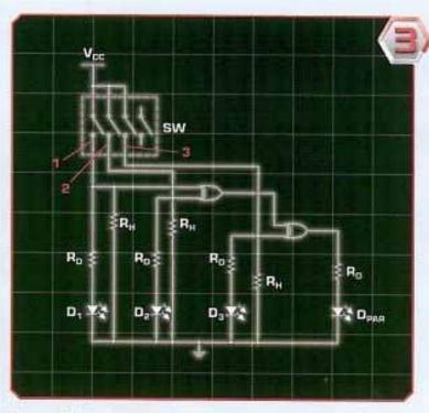
A lato puoi vedere mostrato il circuito che dovrai realizzare. Come al solito andrà alimentato per mezzo di un portapile da quattro pile 'stilo', i cui fili saranno associati al terminale V<sub>cc</sub> e alla massa del circuito. Ricordati che a tali terminali dovranno essere collegati anche i pin 14 (Vcc) e 7 (GND) del circuito integrato 74HC86. I primi tre interruttori del microswitch (SW) ti consentiranno di impostare il valore delle tre linee di ingresso al circuito.
