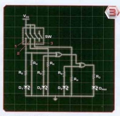
A lato puoi vedere mostrato il circuito che dovrai realizzare. Come al solito andrà alimentato per mezzo di un portapile da quattro pile 'stilo'. i cui fili saranno associati al terminale V<sub>cc</sub> e alla massa del circuito. Ricordati che a tali terminali dovranno essere collegati anche i pin 14 (V<sub>cc</sub>) e 7 (GND) del circuito integrato 74HC86, I primi tre interruttori del microswitch (SW) ti consentiranno di impostare il valore delle tre linee di ingresso al circuito.
