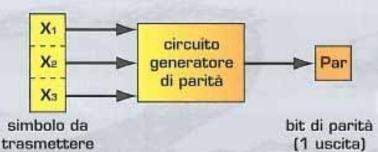
Lo schema del generatore di parità che progetteremo, con tre variabili di ingresso (X<sub>c</sub>) e una di uscita (Par).
