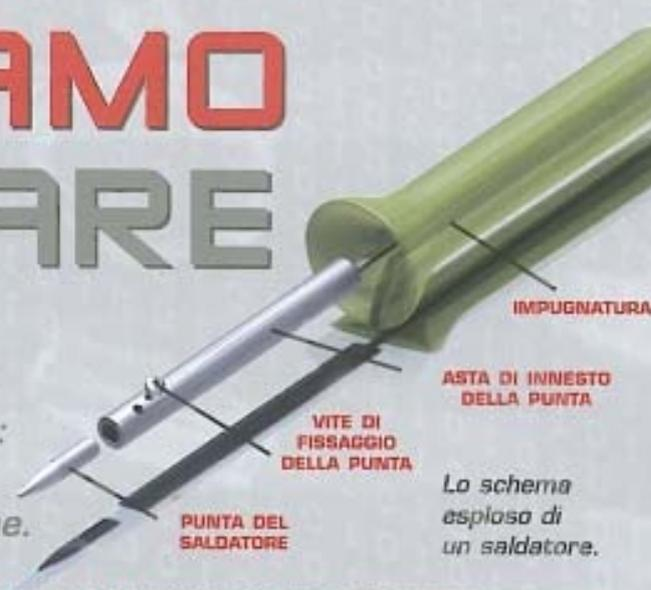
Lo schema esploso di un saldatore.
