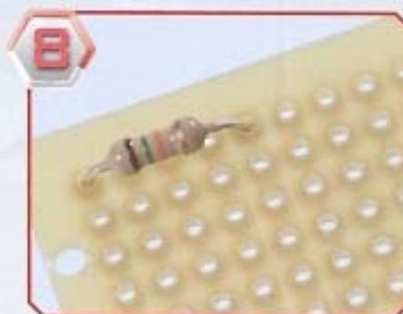
Ecco come appare il resistore al termine della saldatura. Ora esercitati saldando altri componenti elettronici come resistori, diodi o transistor, in modo da fare pratica.
