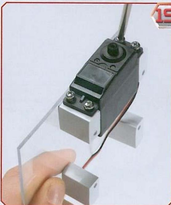
A lato puoi vedere come si presenta il servo fissato con le quattro viti alla struttura del telaio.
