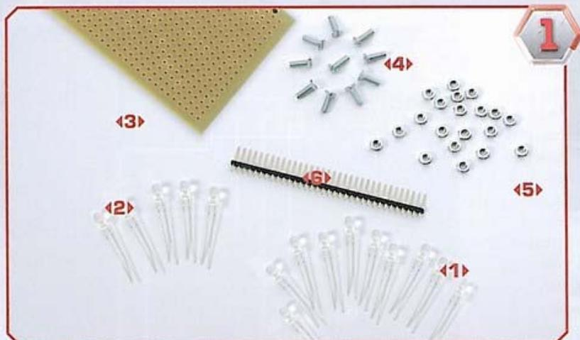
1 10 LED a emissione infrarossa (nel prototipo sono stati impiegati i Kingbright L53SF4C)
