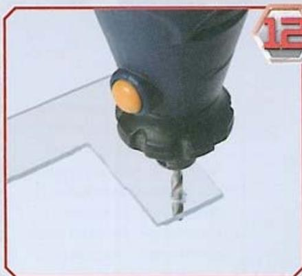
12 Utilizzando il trapano realizza due fori da 3 mm di diametro nei punti segnati in precedenza sul telaio.
