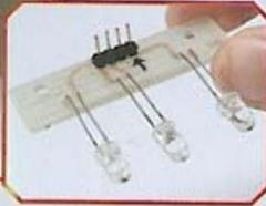
Dopo aver realizzato tutti e cinque i terminali dei sensori devi procedere alla foratura del supporto per il loro montaggio. Per far ciò appoggia il supporto e posiziona il primo dei sensori sul lato sinistro facendo combaciare gli spigoli esterni dei due elementi, come mostrato in figura. Con un pennarello ad alcol segna la posizione dei due fori.
