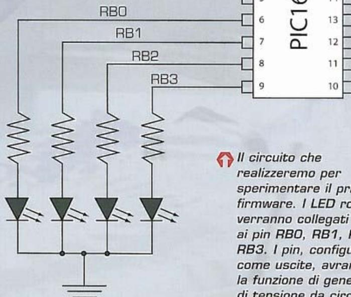
Il circuito che realizzeremo per sperimentare il primo firmware. I LED rossi verranno collegati ai pin **RB0**, **RB1**, **RB2**, **RB3**. I pin, configurati come uscite, avranno la funzione di generatori di tensione da circa 5 V.
