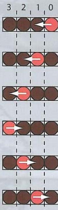
La sequenza di illuminazione dei LED che vogliamo riprodurre equivale a un susseguirsi iterativo di shift binari da una cella. La sequenza binaria è visibile nella tabella in alto a destra.
