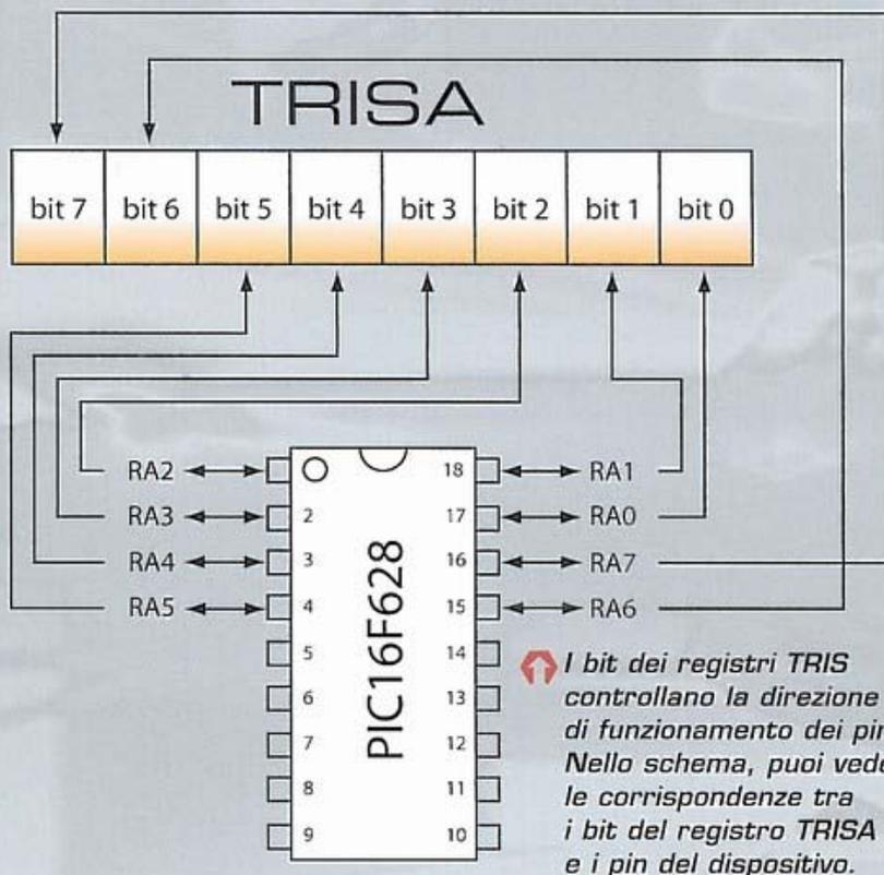
**N**el fascicolo 56 abbiamo introdotto il PIC 16F628 e presentato alcune delle sue caratteristiche peculiari a livello di hardware interno. Facciamo ora un passo avanti e cominciamo ad affrontare i primi passi per la sua programmazione. Le pagine
