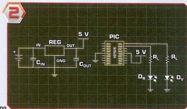
Ecco come apparirà il circuito una volta che lo avrai assemblato. Se lo avrai montato correttamente, non appena collegherai l'alimentazione il **PIC** accenderà i **LED** in modo **intermittente**. Noterai, tuttavia, che i **due diodi** non lampeggeranno esattamente alla stessa frequenza. Questo per due semplici motivi: innanzitutto gli interrupt non sono generati ogni **250 msec esatti**, a causa
