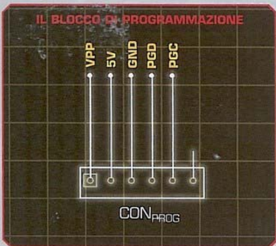
Il blocco del connettore per la programmazione 'on board', che ti permette di programmare il PIC senza rimuoverlo dalla scheda.
