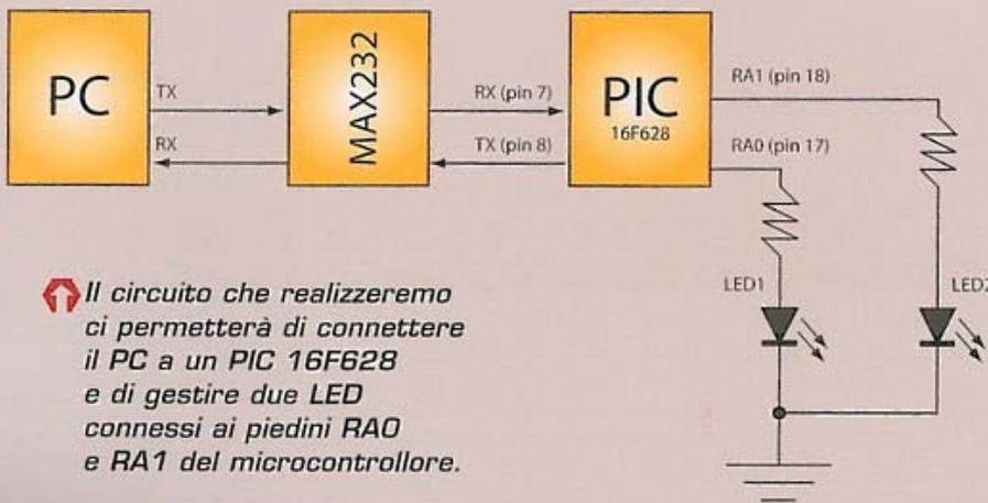
Il circuito che realizzeremo ci permetterà di connettere il PC a un PIC 16F628 e di gestire due LED connessi ai piedini RA0 e RA1 del microcontrollore.
