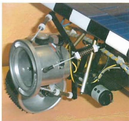
Il sensore tipo spettrometro posizionato nella zona anteriore del robot realizza una simulazione del comportamento del sensore reale. È motorizzato e si può estrarre o ritirare.
