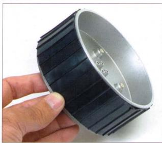
Nell'immagine puoi vedere il cerchione interno della ruota con il battistrada montato. È necessario solamente aggiungere il coprimozzo, che verrà fissato mediante delle viti al cerchione interno completando così la ruota. Nella parte interna della ruota verrà montato un motoriduttore con potenza sufficiente per fornire il movimento in avanti e indietro a ognuna delle ruote del veicolo spaziale.
