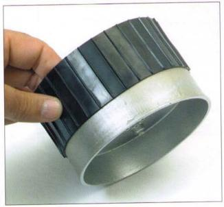
Il battistrada deve essere montato in modo che ricopra completamente la superficie della ruota. Grazie alla dilatazione a cui è stato sottoposto il battistrada rimarrà fissato saldamente e non slitterà sul cerchione quando il motore lo farà girare. Ricorda che il battistrada è in costante tensione sul pezzo interno, e che tutto il peso del veicolo è sopportato dalle ruote.
