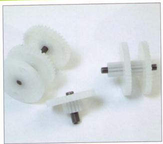
Questi tre pezzi sono i meccanismi riduttori che si inseriscono nella parte interna della scocca di ogni motore per aumentare la coppia di uscita dello stesso. Uno degli ingranaggi sarà in contatto direttamente con il motore e trasmetterà il movimento a tutti gli altri fino a ottenere un movimento lento e potente nell'elemento di uscita.
