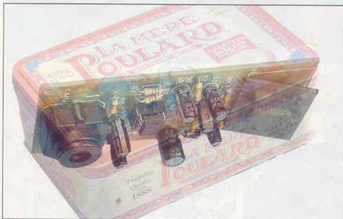
Viste le ridotte dimensioni, il circuito TX televisivo è facilmente installabile in qualsiasi ambiente; inoltre, la particolarità dell'obiettivo (di tipo pin-hole) consente di nascondere tutto il dispositivo all'interno di qualsiasi oggetto come, ad esempio, una scatola di biscotti. È sufficiente predisporre un piccolo foro da dove la telecamera possa "vedere" l'esterno.
